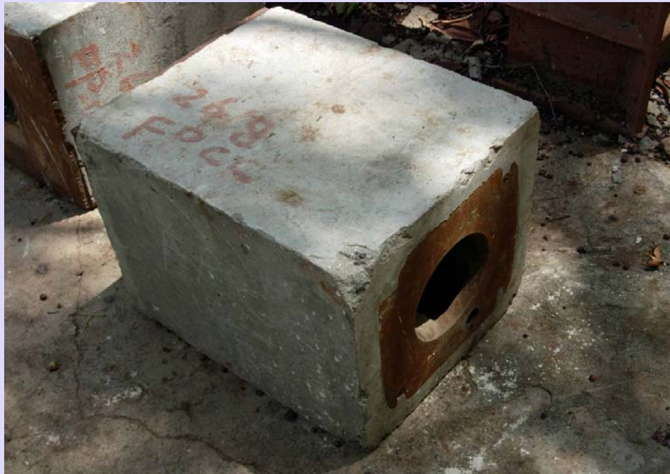
(d) End block after casting
